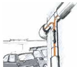
Frostschutz von exponierten Rohrleitungen
